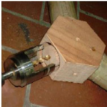
Fig.16 - unión con madera - BAMBUTEC
